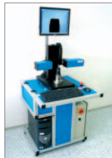
Zařízení MesTool měří parametry obráběcích nástrojů Firma Neovision ve spolupráci s katedrou kybernetiky, ČVUT Praha
