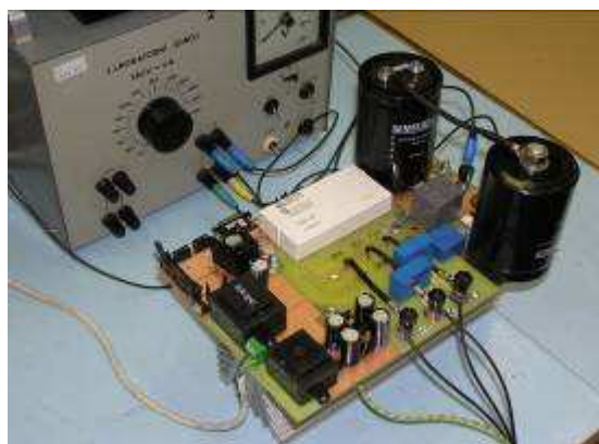
Obr.2 Experimentální IGBT střídač pro vysokootáčkový pohon
