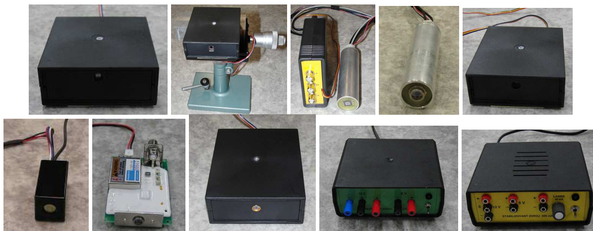
Obr 3 Ukázky příkladů zabudování jednotlivých senzorů, včetně nezbytné elektroniky a zdrojů. Zleva nahoře: 1D PSDS 6873, čtyřdioda S 6695-01, 2D PSD S2044, 2D PSD S 7848-01, senzor barvy. Zleva dole: fotonásobič H 5783, lavinová fotodioda C 5331-04, senzor vlnové délky WS7.56-T05, stabilizovaný zdroj 5V/12V, stabilizovaný zdroj 5V/12V s ovladačem výkonu laseru.
