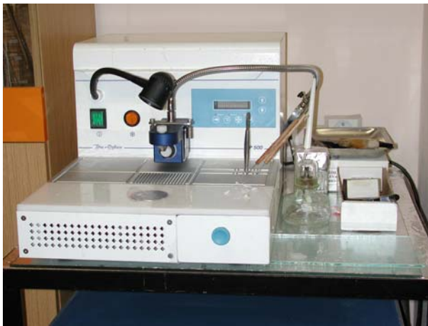
Obr. 8: Zalévání vzorku do parafinových bločků
