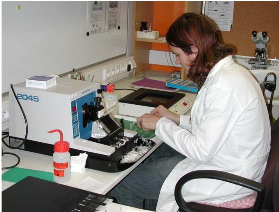
Obr. 10: Krájení na rotačním mikrotomu
