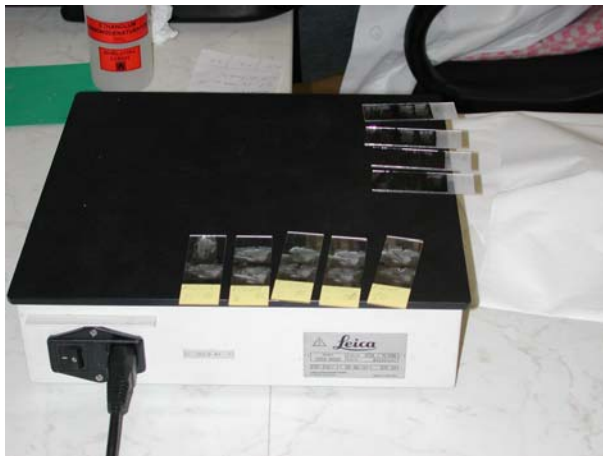
Obr. 9: Sušení řezů na horké ploténce
