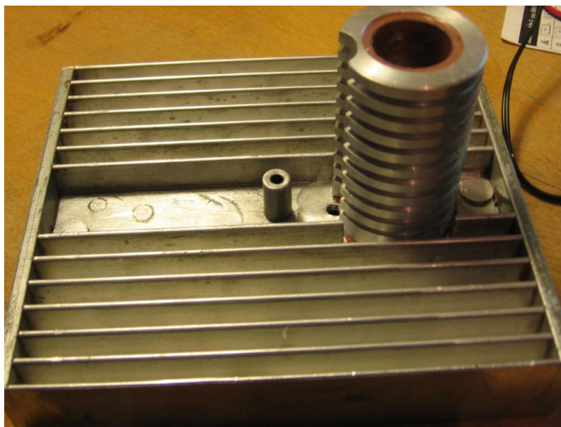
Obr. 1: pracovní válec a víko s chladicími žebry
