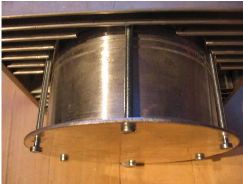
Obr. 2: komora přehaněče, spodní ohřívaná část
