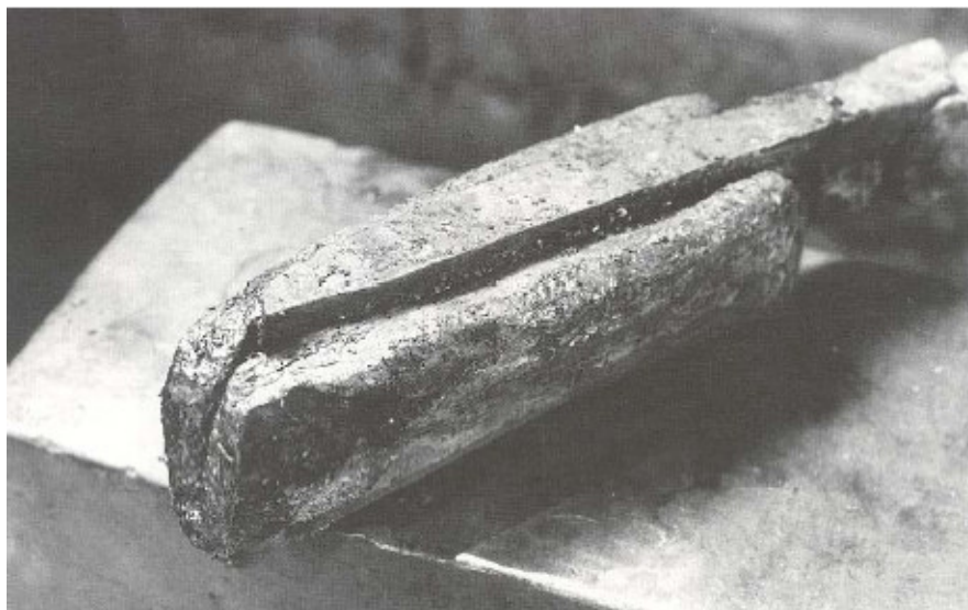
Ilustrace 1: Spojování metodou kobuse gitae. Vpravo průřez hotovou čepelí.
