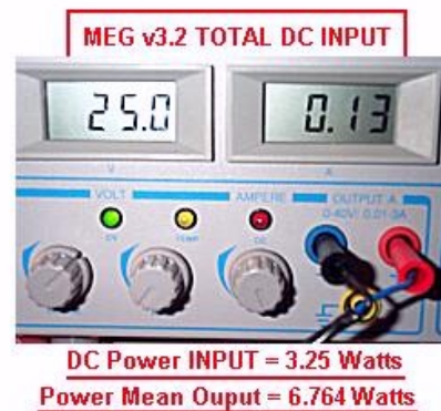
Obr. 12 Ukázka Naudinova MEGu s naměřenými hodnotami
