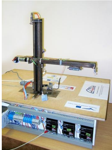
Obr. 2: Robotický jeřáb – práce žáků SPŠS v projektu e-Ants
