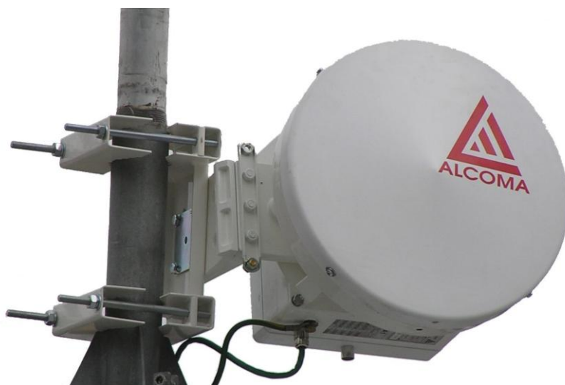
Obr. 4: Anténa pracující v pásmu 10GHz
