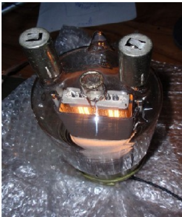
11. obr Výkonová elektronka GU-81m. Z elektronky je vyvedena jak anoda, tak mřížka G3
