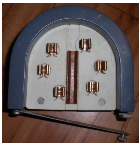
12. obr Patice elektronky GU-81m z
