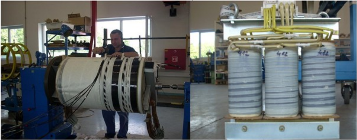
18. obr. Vinutí transformátoru paralelními měděnými pásky a hotové zaizolované trafo
