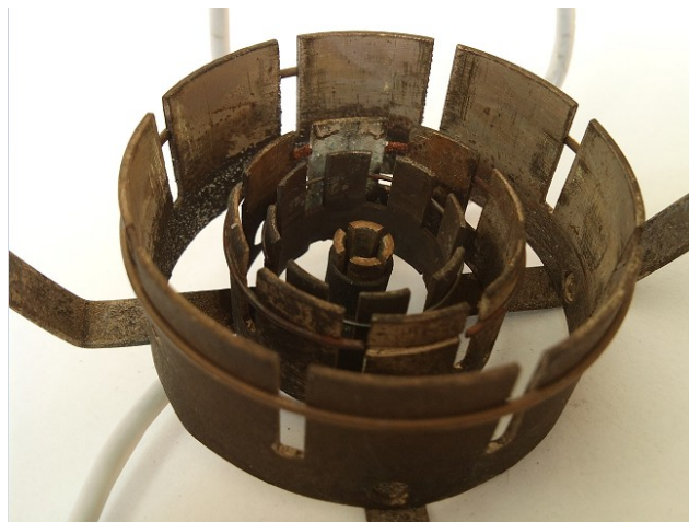
7. obr. Stříbřená stará patice výkonové elektronky GU-43B
