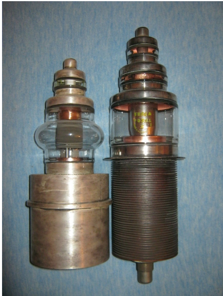
14. obr. zleva usměřňovací elektronka a zprava vysílací trioda o výkonu 3kW. Anodou elektronky jsou již zmínění chladiče.
