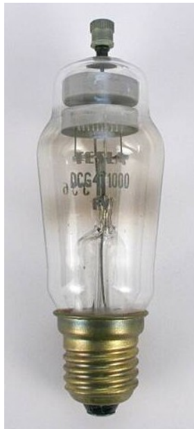
9. obr Patice – žárovkový závit E27, a detail anody.
