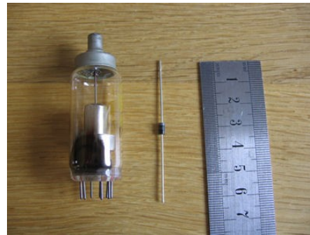
2. obr Porovnání vakuové usměrňovací diody s polovodičovou.
