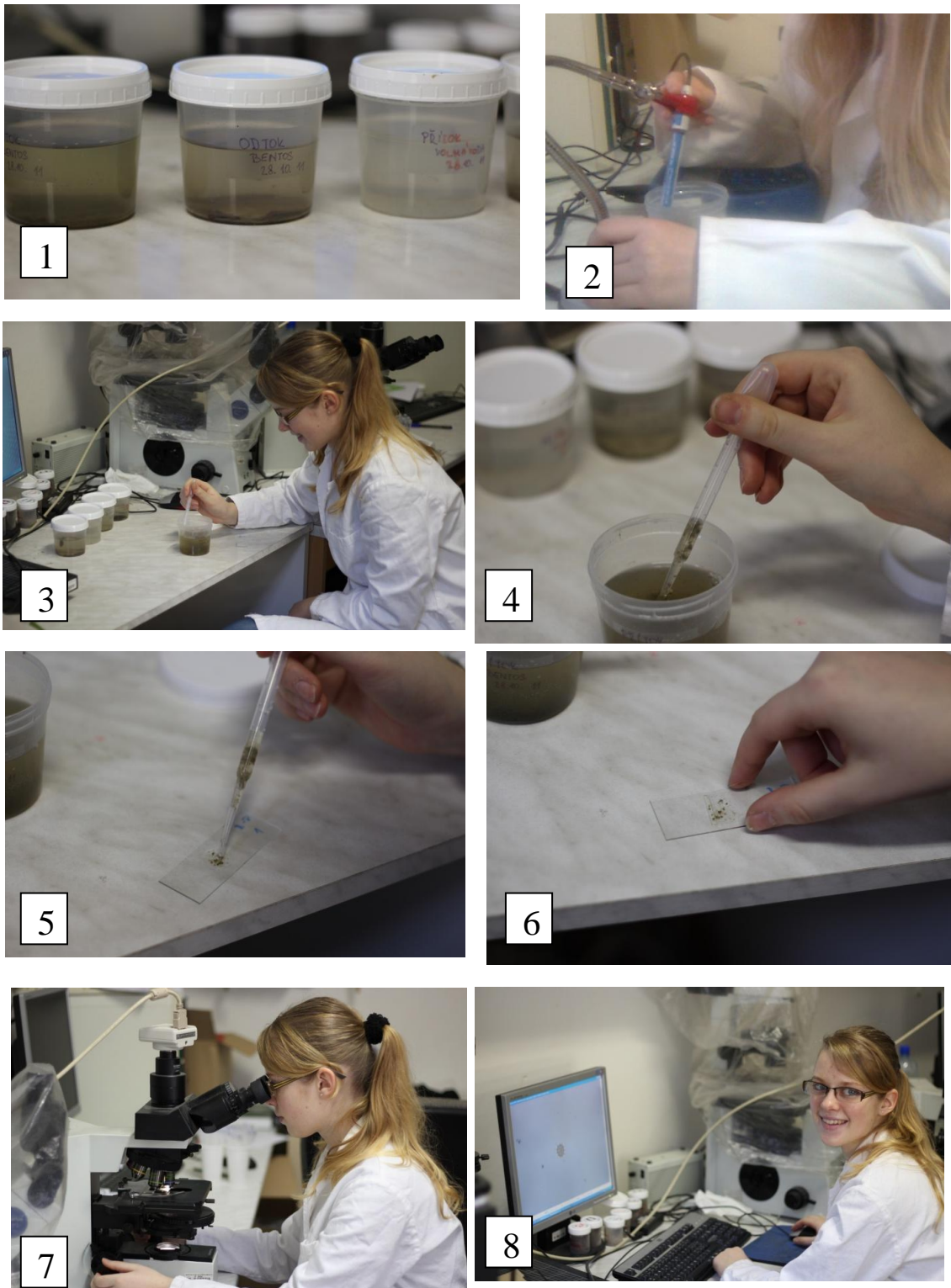
Obrázek č. 13: Příprava nativních preparátů a pozorování: 1: vzorkovnice; 2: měření pH a teploty vody; 3: mýchání kapátkem; 4: nasávání vzorku; 5: kapání na podložní sklíčko; 6: přikrytí preparátu krycím sklíčkem; 7: pozorování; 8: focení vzorků
