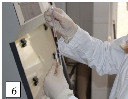
Obrázek č. 18: Příprava trvalých preparátů: 1: popisování zkumavek; 2: popisování kapátek; 3: odměření 1,5 ml vzorku; 4: přidání 1 ml \text{HNO}_3 ; 5: vaření ve vodní lázni; 6: přidání \text{KMnO}_4
