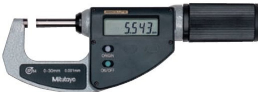
Obrázek 13 - Digitální třmenový mikrometr s přesností na 0,001 mm
