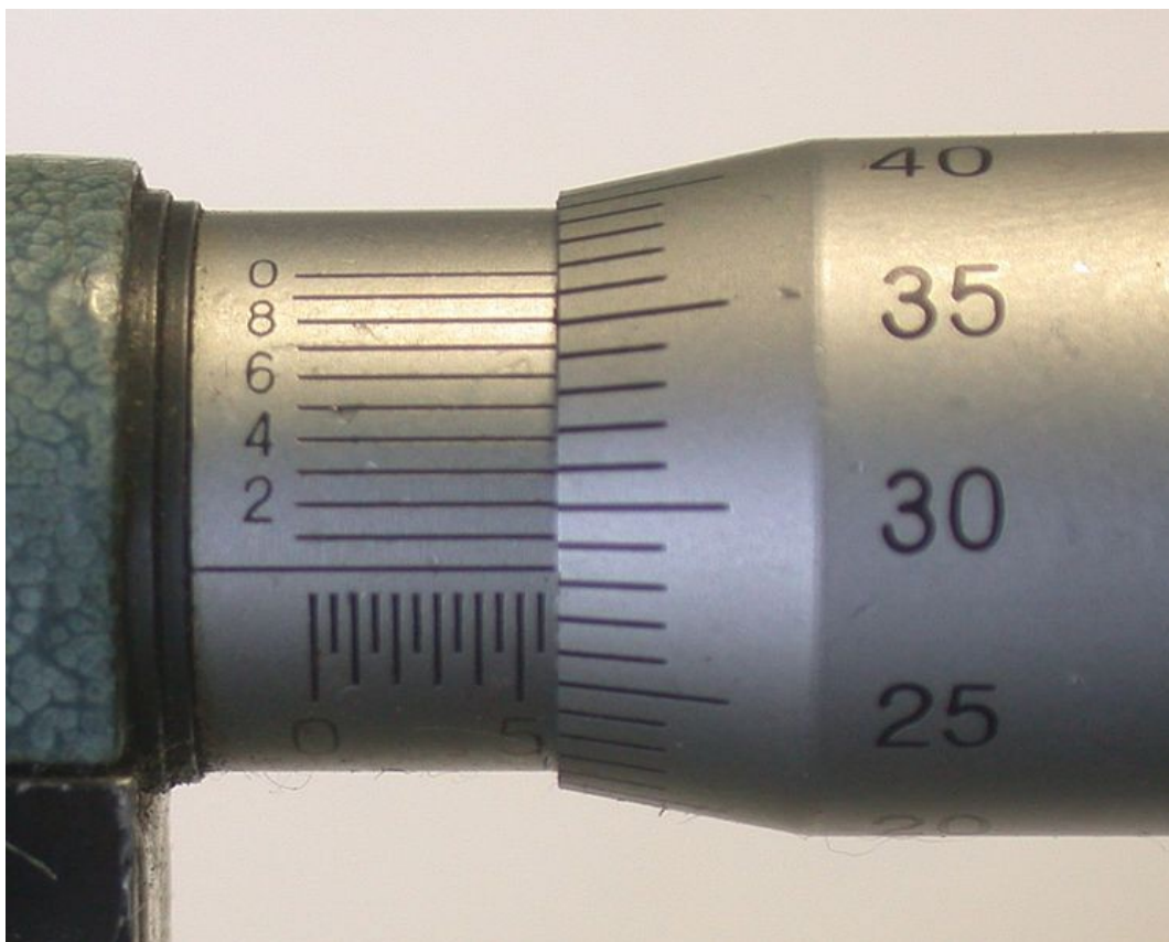
Obrázek 22 - Odečítání pomocí nonia u mikrometru (u starých mikrometrů)
