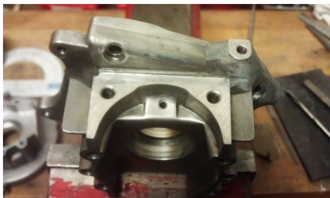
Obr. 102 – Mazací kanálek (uprostřed)
