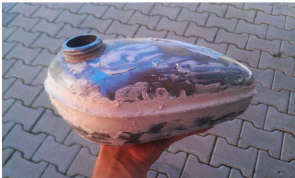
Obr. 72 – Nádrž po tmelení
