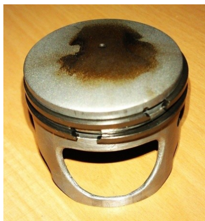
Obr. 39 – Píst s usazeninami
