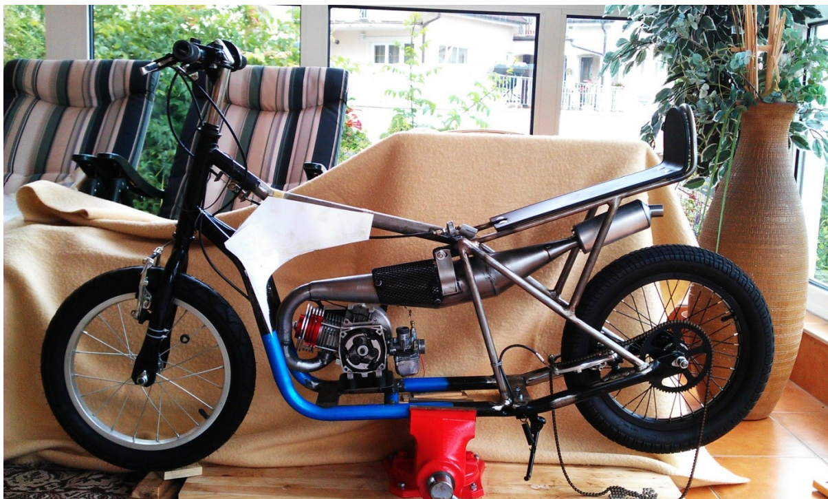
Obr. 77 – Navrhování tvaru nádrže (motocykl upnut do svěráku)
