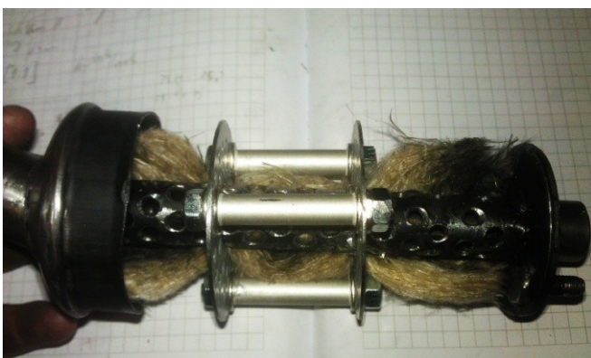
Obr. 94 – Vnitřek tlumiče s tlumící vatou
