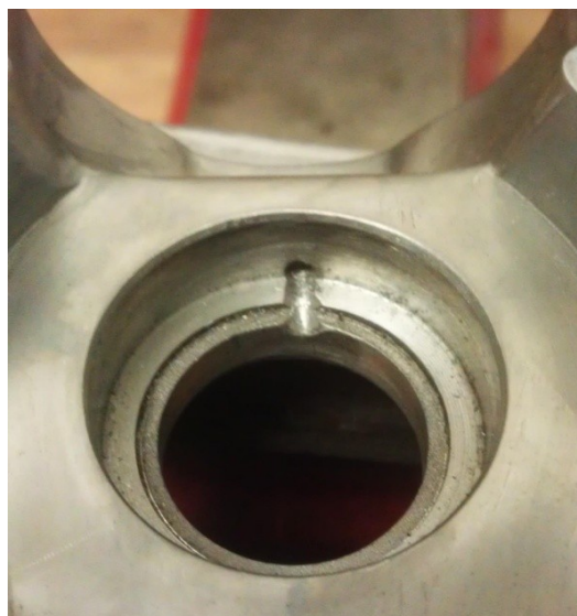
Obr. 103 – Detail na mazací kanálek
