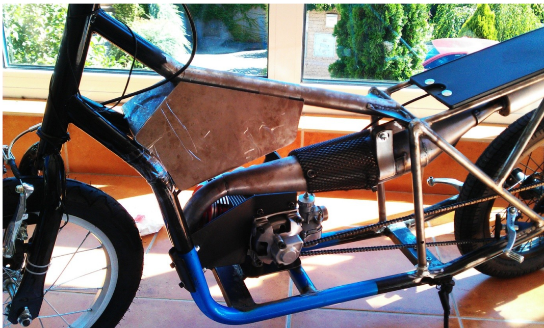
Obr. 82 – Motocykl s provizorně připevněnou nádrží
