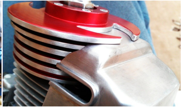
Obr. 25 – Detail na slícování krytu startéru s hlavou válce
