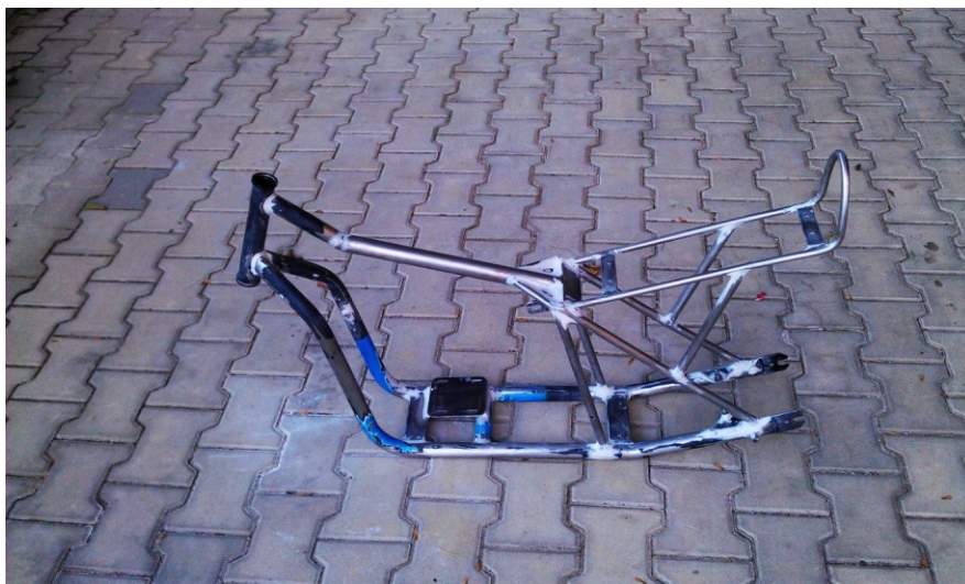
Obr. 45 – Rám po tmelení připravený na nástřik
