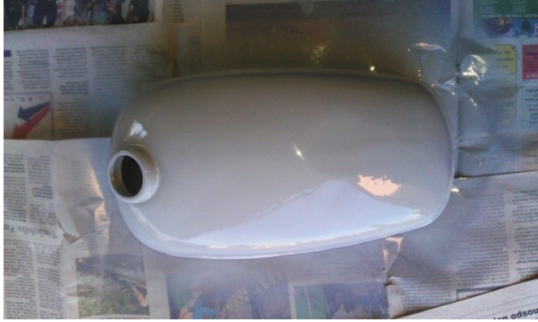
Obr. 74 – Nádrž nastříkaná základovou barvou
