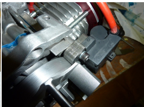
Obr. 23 – Detail na mezeru mezi pacičkami zapalovací cívky a ventilátorem
