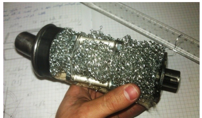
Obr. 95 – Vnitřek tlumiče s vatou a drátěnkami
