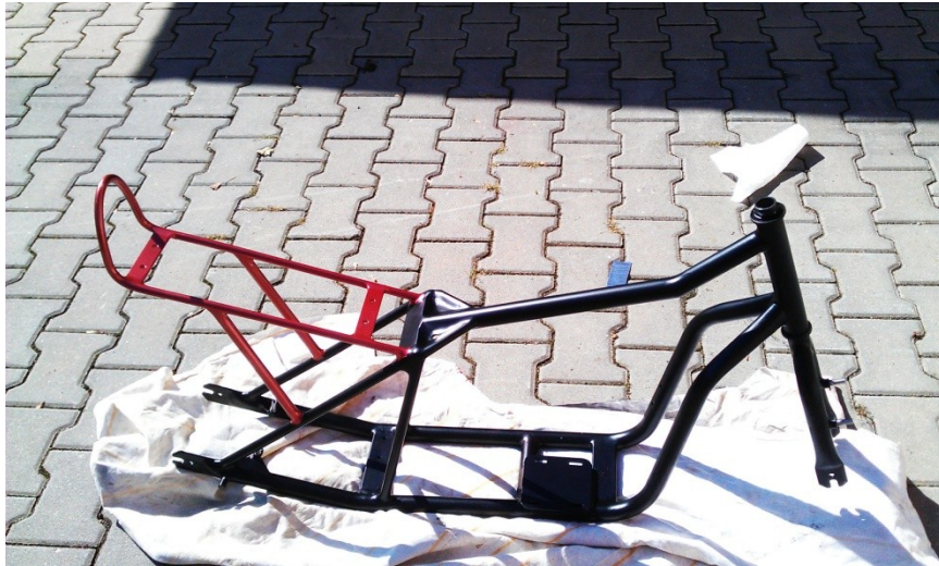
Obr. 47 – Kompletně nastříkaný rám
