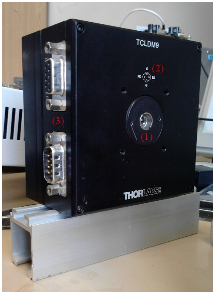
Obrázek 7 - Laserové zařízení použité k měření proudových charakteristik
