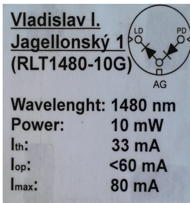
Obrázek 5 – Štítek laserové diody použité při měření proudových charakteristik
