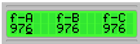
Obr. 2.3.2—14 Nabídka nastavení frekvencí s nastavenou hodnotou 976 Hz pro PWM-A, PWM-B a PWM-C 42
