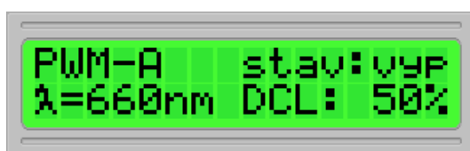
Obr. 2.3.2—6 Nabídka nastavení výstupu ve vypnutém stavu a s hodnotou střidy 50 % 34
