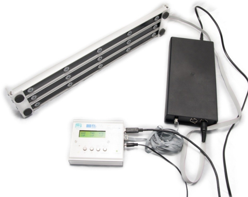
Příloha č. 5 Řídicí jednotka DR-12, zdroj napájení LED panelů, LED panel
