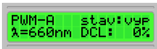
Obr. 2.3.2—5 Nabídka nastavení výstupu ve vypnutém stavu a s hodnotou střidy 0 % 33
