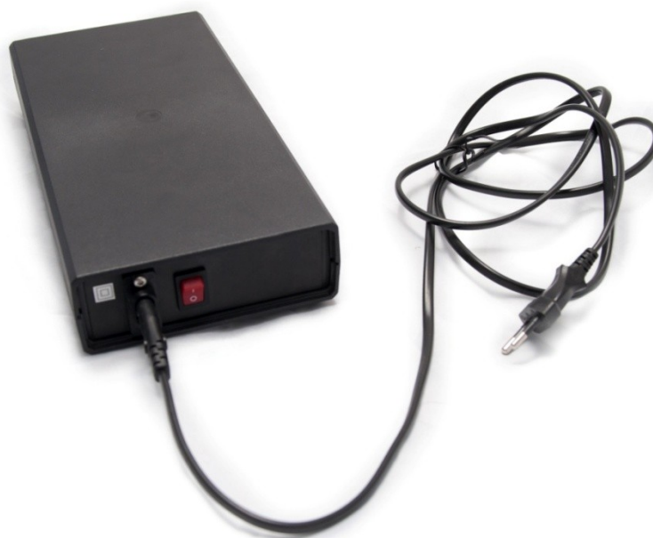
Příloha č. 2 Zdroj napájení LED panelů, strana s vypínačem
