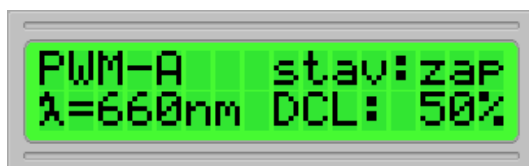
Obr. 2.3.2—7 Nabídka nastavení výstupu v zapnutém stavu a s hodnotou střídání 50 % 35
