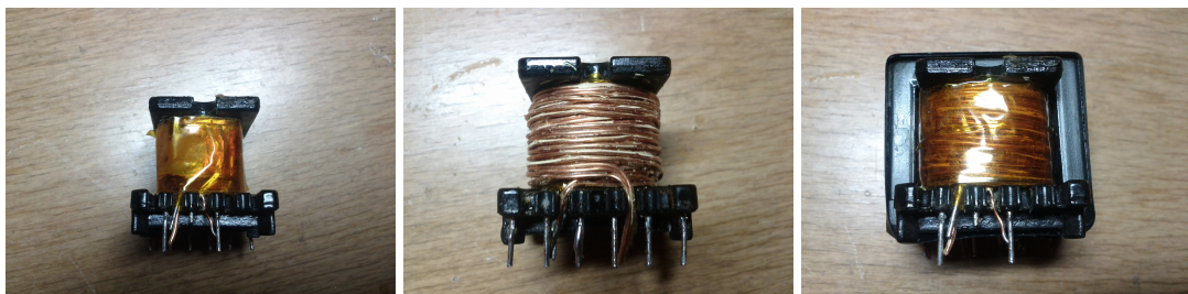
(d) Převinutí transformátoru 4 (e) Převinutí transformátoru 5 (f) Převinutí transformátoru 6
