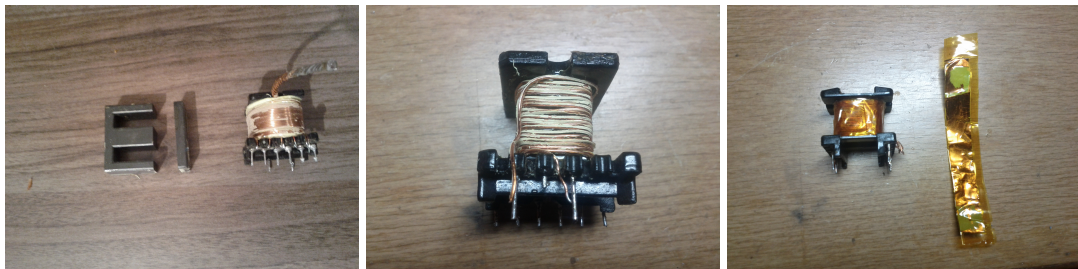
(a) Převinutí transformátoru 2 (b) Převinutí transformátoru 2 (c) Převinutí transformátoru 3
