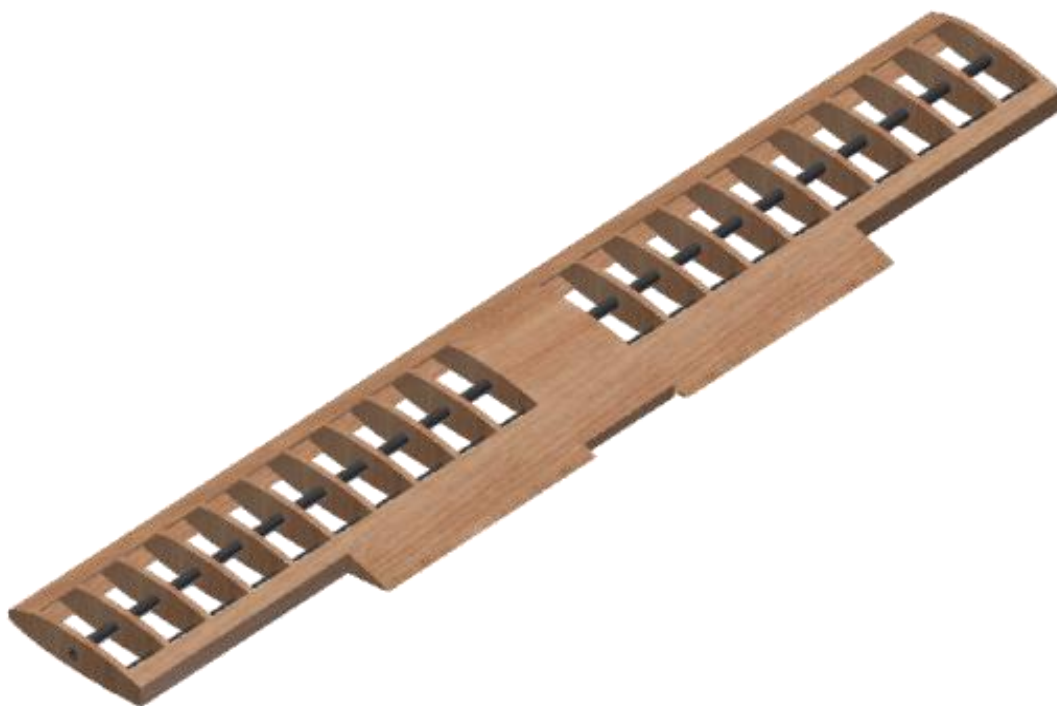
Obrázek 16: Kostra křídla s pevným potahem náběžné a odtokové hrany
