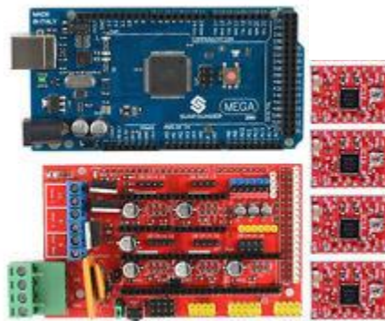
Obrázek 3 : Řídící elektronika - Arduino + RAMPS + 4x ovladač krokových motorků
