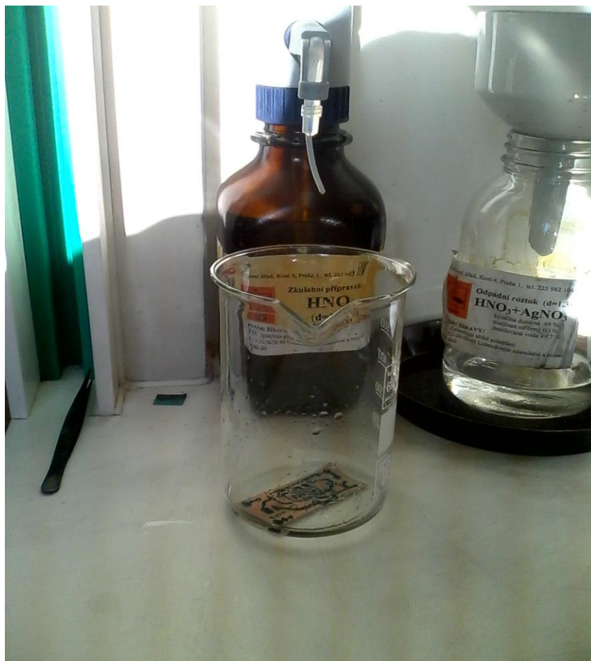
Obrázek 4. 5: Plošný spoj při leptání za použití kyselin.
