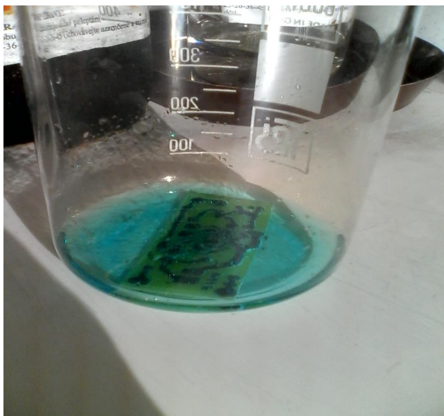
Obrázek 4. 7: Dokončování leptání plošného spoje.
