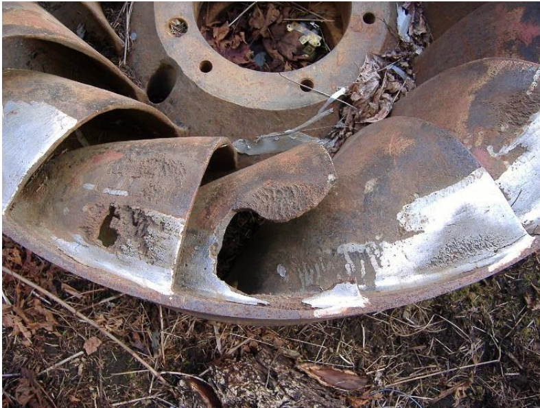
Obrázek 13 Důsledky kavítace na oběžném kole
