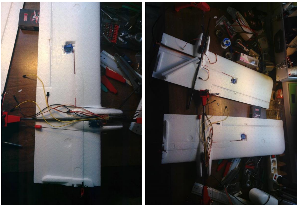
Obr. 13 – Osazení elektroniky a kabelů na křídlech
