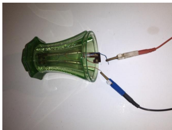
OBR. 15 MĚŘENÍ URANOVÉHO SKLA Z TĚSNÉ BLÍZKOSTI
