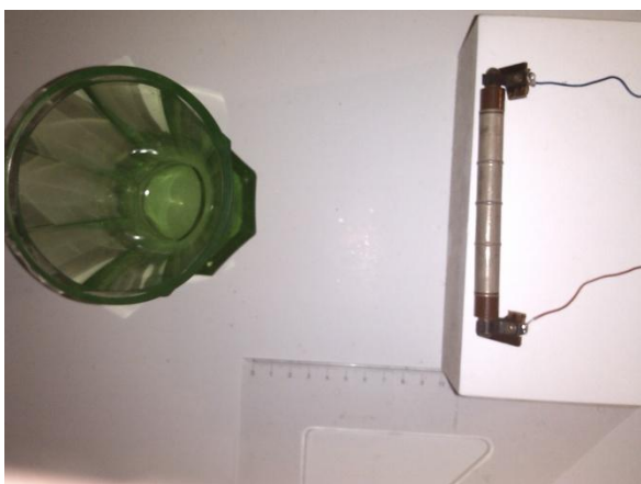
OBR. 14 MĚŘENÍ URANOVÉHO SKLA ZE VZDÁLENOSTI 10 CM
