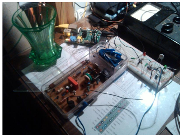
OBR. 13 MĚŘENÍ AKTIVITY VÁZY Z URANOVÉHO SKLA ZE VZDÁLENOSTI 5 CM
