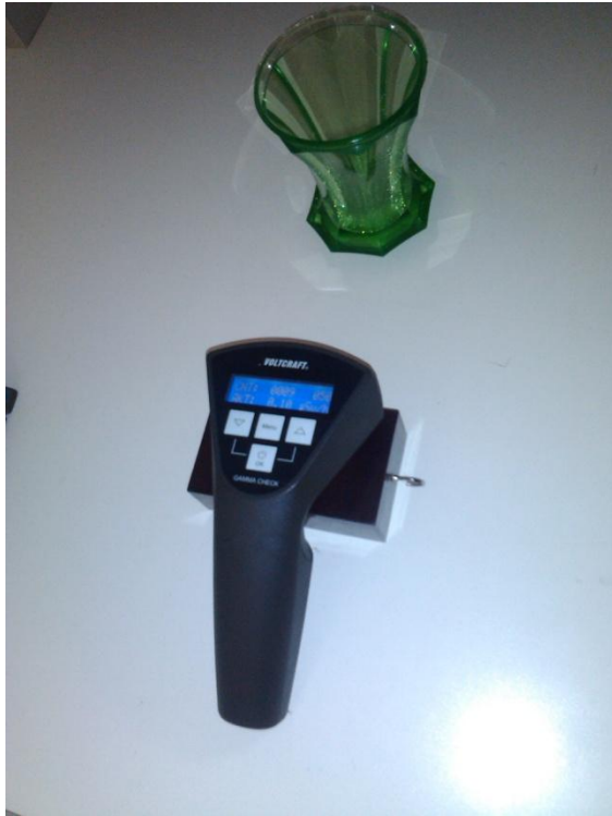
OBR. 16 MĚŘENÍ URANOVÉHO SKLA Z 10 CM POMOCÍ WOLFCRAFT GAMMA CHECK
