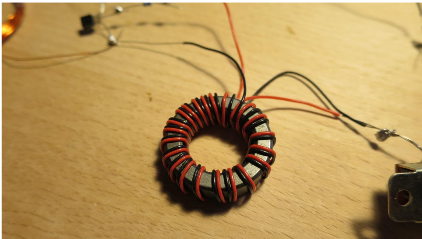
Obr. č. 4: Detail feritového toroidního jádra s navinutými cívkami; (zdroj: archiv autora)
