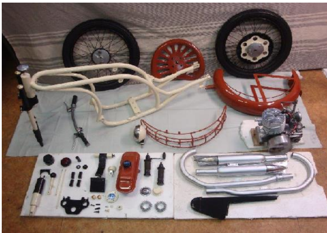
Obr. 4 : Komponenty výrobku – podíl práce studentů studijního oboru KNO3 (nástrojař)
