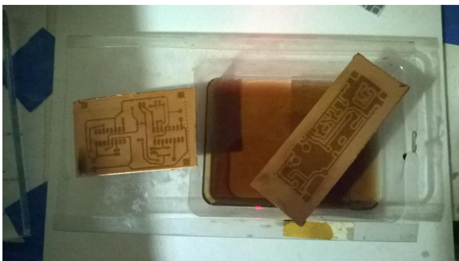
Obr. 32: Pohled na připravené plošné spoje k leptání
