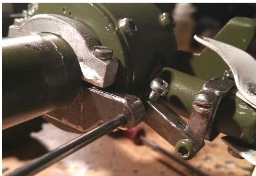
Obr. 18 Vyrobené odpružení podle 3D modelu
