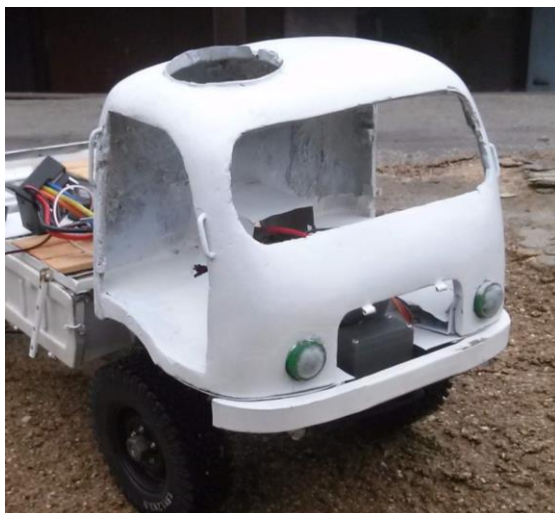
Obr. 5 Kabina po přebroušení a základním laku
