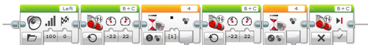
Obr. 7: Úsek programu otočení zpět
