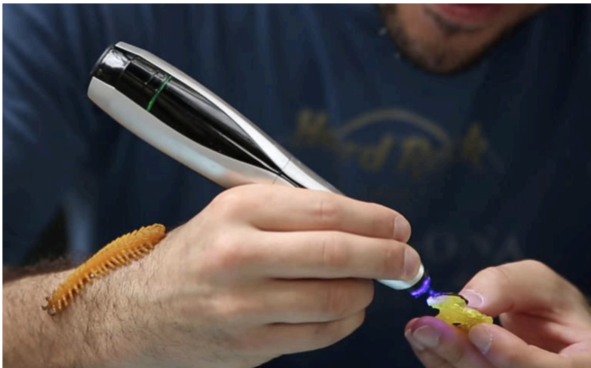
Obr 6: Pryskyřicové 3D pero CreoPop (staženo z internetu)
