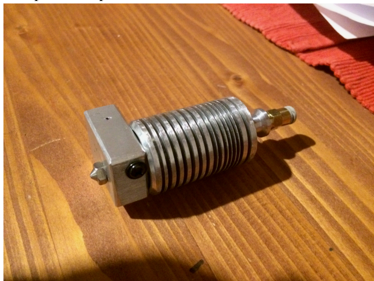
Obr 12: Nový hotend s chladičem, tryskou a fitinkou
