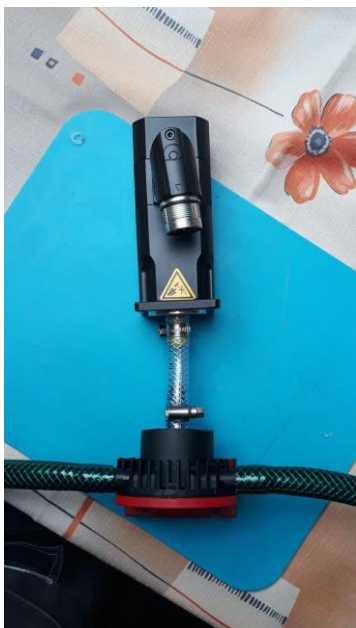
Obr. 3.5 – Spojení čerpadla a motoru
