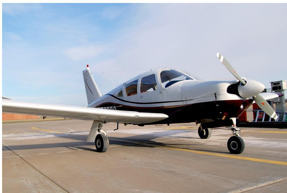
Obrázek 30 - letadlo s vrtulí držící stálou rychlost otáček
