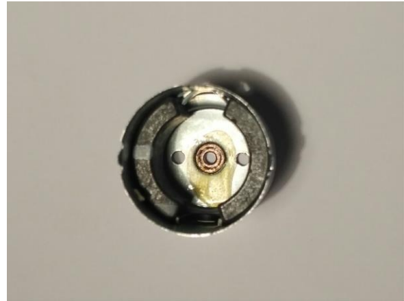
Obrázek 2 - stator elektromotoru s permanentním magnetem
