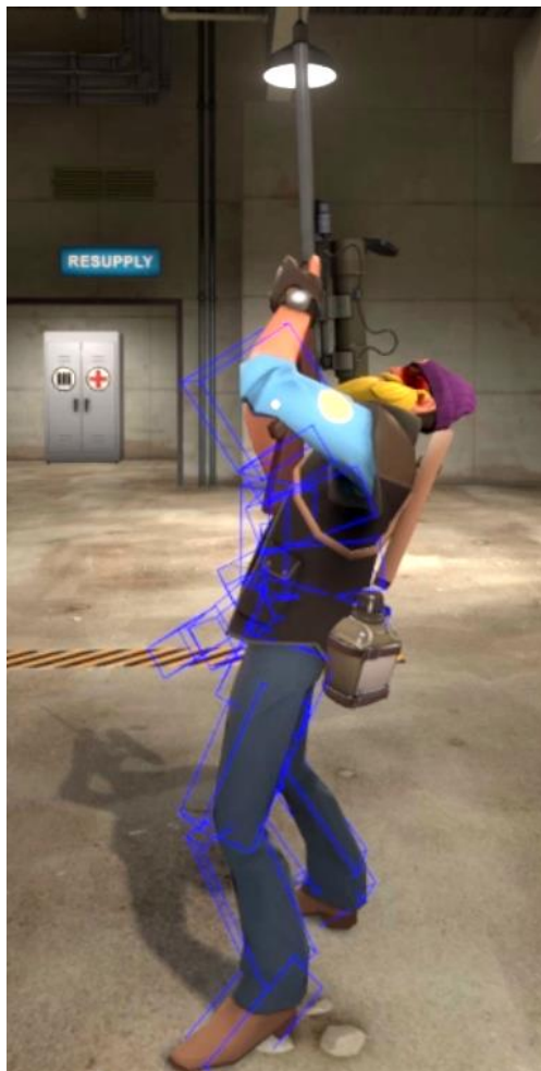
Obrázek 5: Rozdíl mezi vykreslovaným modelem a hitboxem (modré kvádry)
