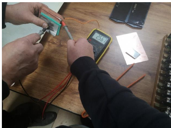
Obrázek 17 Zde měříme velikost elektrického proudu multimetrem [9]
