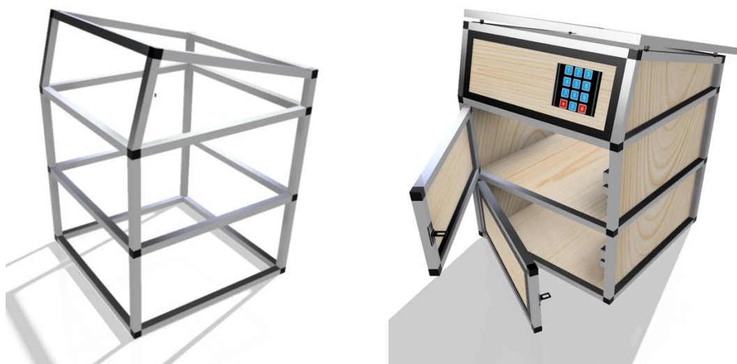
Obrázek 2 – návrh rámové konstrukce zařízení a celkový digitální prototyp
