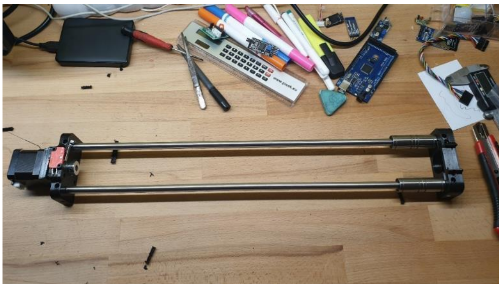
Obrázek 9: první prototyp základny osy X
