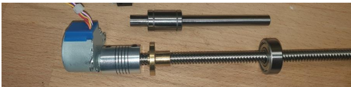
Obrázek 21: pohybová soustava osy E
