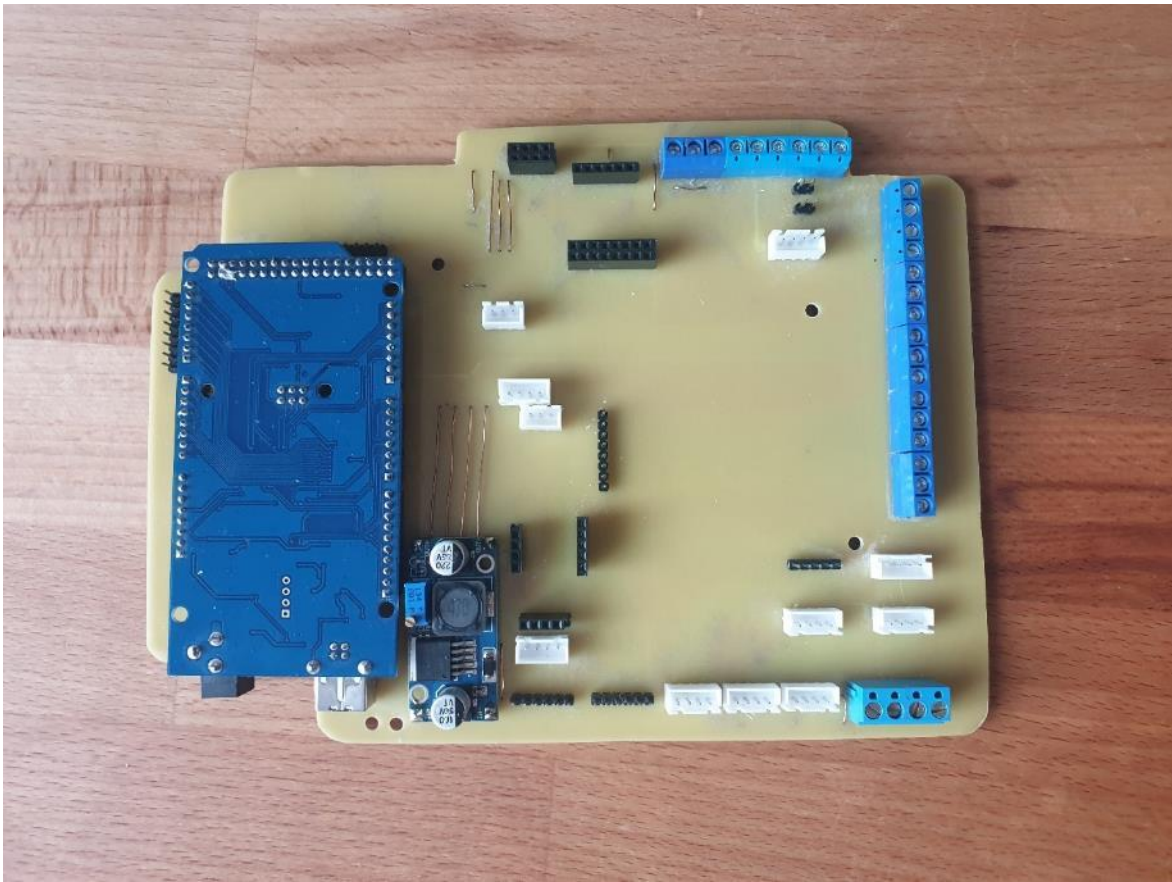
Obrázek 25: osazená základní deska
