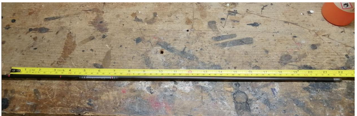
Obr. 7, šíp rozdělený na dílky pro usnadnění měření
