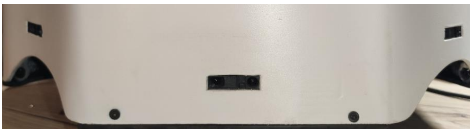
Obrázek 9: Rozložení senzorů na přední straně robota (vlastní tvorba)
