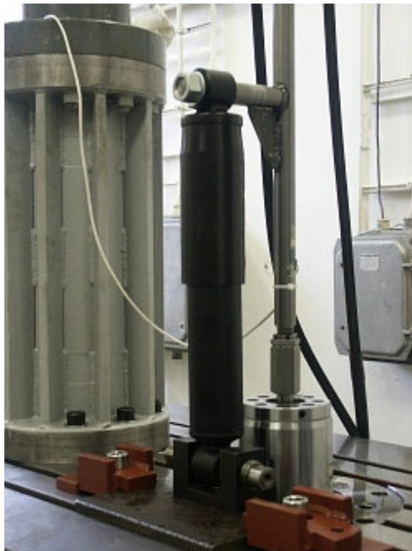
Obr.6: Mechanická zpětná vazba druhé úrovně s přidaným tlumičem (simulace reálné soustavy)
