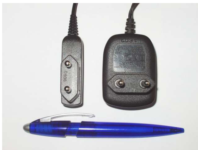
Obr.6: Nabíjačky mobilných telefónov – vľavo so spínaným zdrojom 5V/420mA, vpravo konvenčná 5V/300mA
