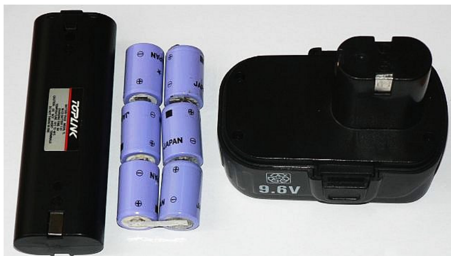
Obr.2: Usporiadanie akumulátorových blokov vŕtačiek - vľavo starší 7,2 V, vpravo 9.6 V
