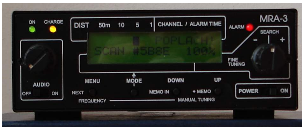
Obr.3: Přehledový radiopřijímač MRA-3 (zaznamenán odposlech – poplach)
