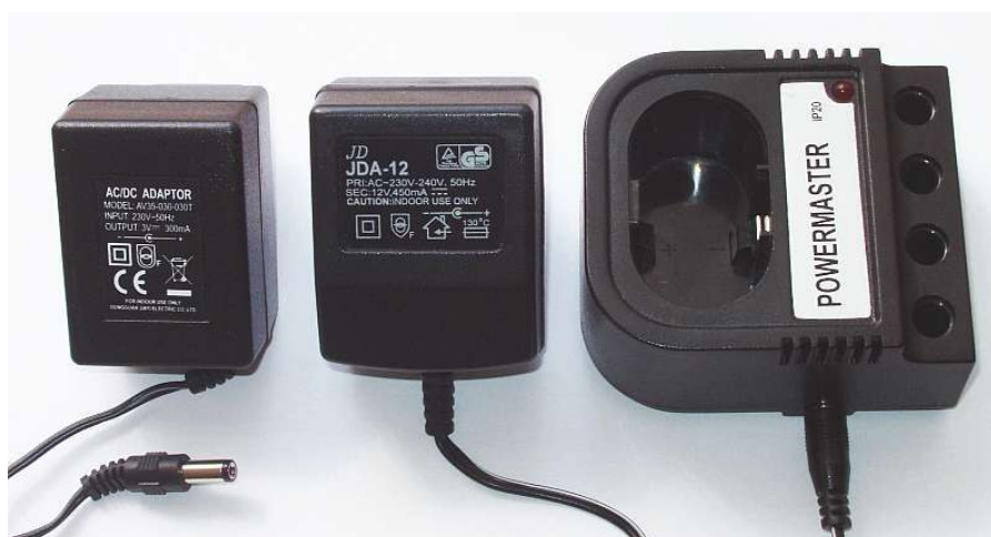
Obr.7: Riešenia zdrojov pre nabíjanie elektrického náradia – vľavo skrutkovača, vpravo vŕtačky
