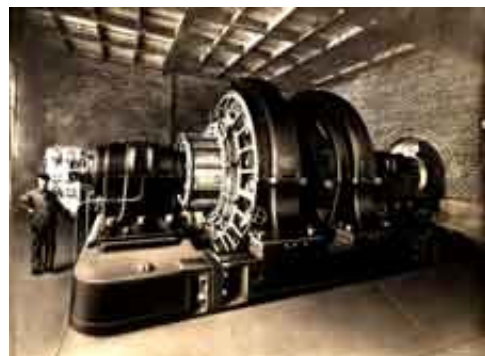
Obr. 14: Prvý reverzujúci motor pre valcovňu plechu
